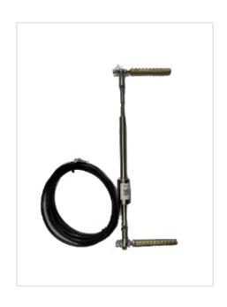
收缩式振弦式大程量位移计适用于长期测量水工结构物或其它混凝土结构物伸缩缝的开合度(变形),亦可用于测量土坝、土堤、边坡等结构物的位移、沉陷、应变、滑移,并可同步测量埋设点的温度和智能识别功能。振弦式单点位移计适用于长期测量水工结构物或其它混凝土结构物与基础(基岩、土体、砂体、软基等)之间的位移值(开合度、沉降量、隆起变形量),亦可用于测量土石坝、边坡、地基等构筑体或其它回填土体的位移值,并可同步测量埋设点的温度和智能识别功能。
