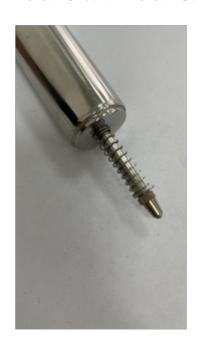
光纤光栅位移计内除了有一支测力光栅外,还串有一支温度光栅,其作用为温度测量与压力温度修正。如果光纤光栅位移计在埋设后出现波长消失、解调误差偏大等情况可以按照以下方式检查:用酒精擦拭法兰连接
